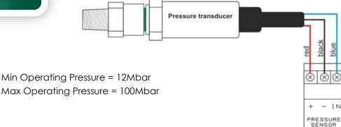
ENSURE THIS IS WIRED AS PICTURED & SCREWED TO THE DOWNSTREAM PORT OF THE GAS SOLENOID VALVE
