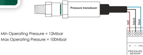
ENSURE THIS IS WIRED AS PICTURED & SCREWED TO THE DOWNSTREAM PORT OF THE GAS SOLENOID VALVE
