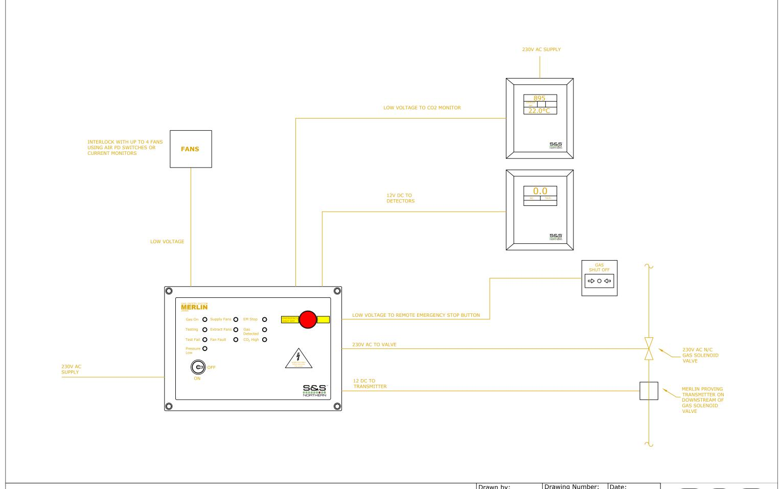
MERLIN 2000S GAS PROVING & VENTILATION INTERLOCKING SYSTEM
